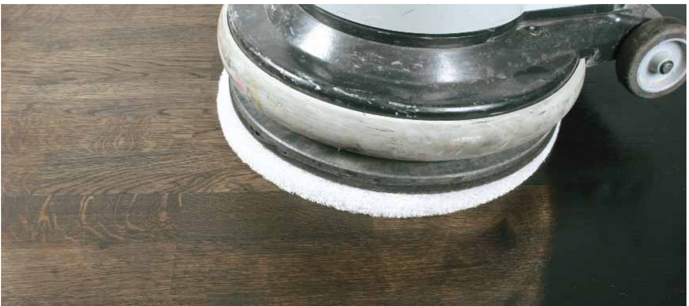
7) Strojní zpracování Osmo Barevného oleje
